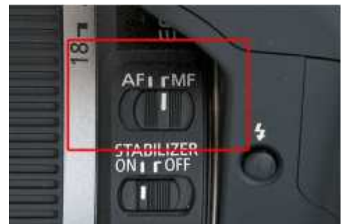
afb 3 | knopje op de lens voor het omzetten van autofocus (AF) naar handmatig scherpstellen (MF)
