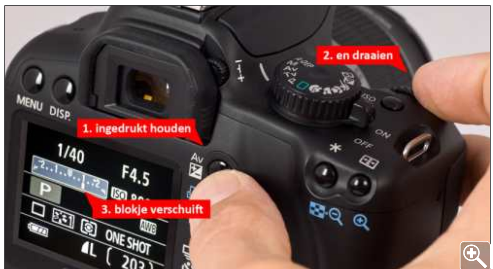
afb 5 | het instellen van belichtingscompensatie op een EOS 1000D en xxxD-serie.
