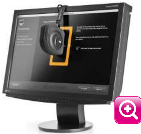
afb 1 | ColorMunki colorimeter klaar voor actie om een beeldscherm te kalibreren.
