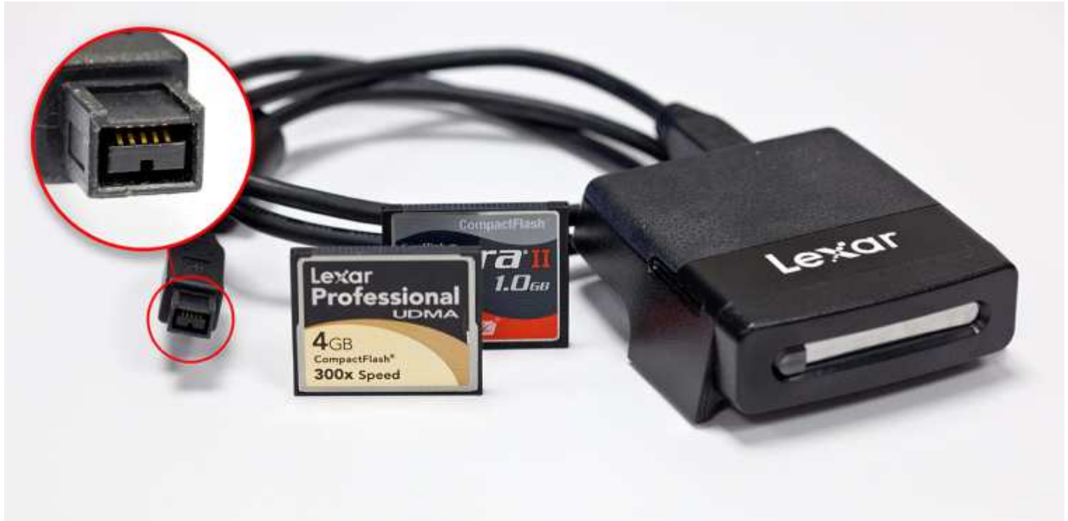
afb. 2 | Firewire 800 kaartlezer met aansluiting. CF Ultra II en CF UltraDMA-geheugenkaartjes.
