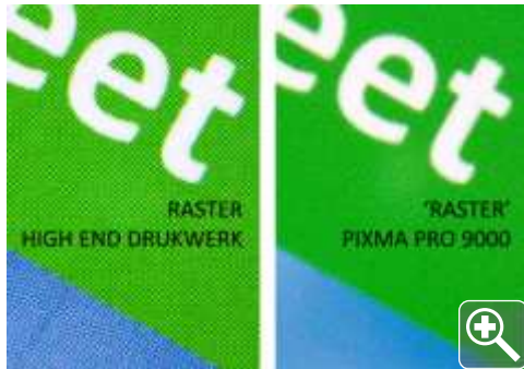
afb. 2 | voorbeeld van het fijne raster van een PIXMA Pro printer ten opzichte van high-end drukwerk op glossy papier.
