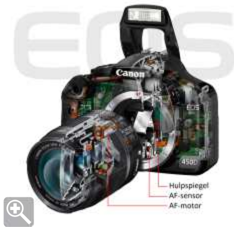
afb 1 | de werking van autofocus (AF)
